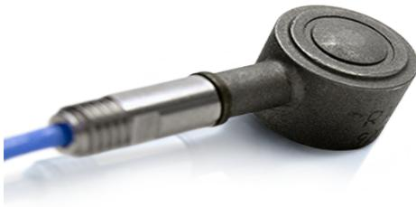
El sensor 9204 de uno o varios canales es una cavidad piezoeléctrica digital indirecta (clavija inferior), tipo botón, de 12,60 mm (0,496 pulg.) presión sensor diseñado para su uso con los sistemas de control y monitoreo de procesos RJG eDART® y CoPilot®.
