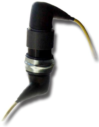
El conector de anillo deslizante Lynx™ CLXS-R2MM90 permite la conexión de sensores Lynx montados en moldes de mesa giratoria al sistema eDART o CoPilot de RJG, Inc. El C-LX-SR-2M-M90 está montado directamente en la mesa giratoria y permite una rotación completa de 360 grados entre las conexiones Lynx.
