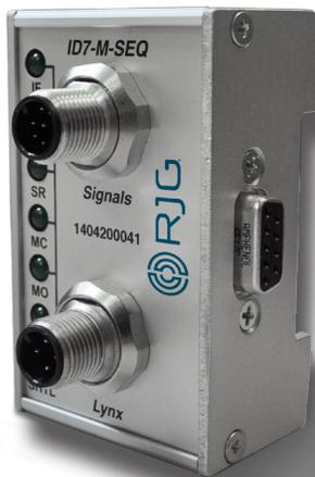
Este módulo de riel DIN blindado con secuencia de Lynx proporciona al sistemas eDART® o CoPilot secuencias de sincronización de 24 V CC, que incluyen alimentación de inyección, carrera de tornillo, molde cerrado, primera etapa y apertura del molde. Se requiere el uso de un módulo ID7-M-SEQ (o DIN / LX-D) para conectarse físicamente al sistema eDART. Este módulo de riel DIN está blindado para asegurar datos de alta calidad, incluso en entornos de moldeo bajo condiciones difíciles.
