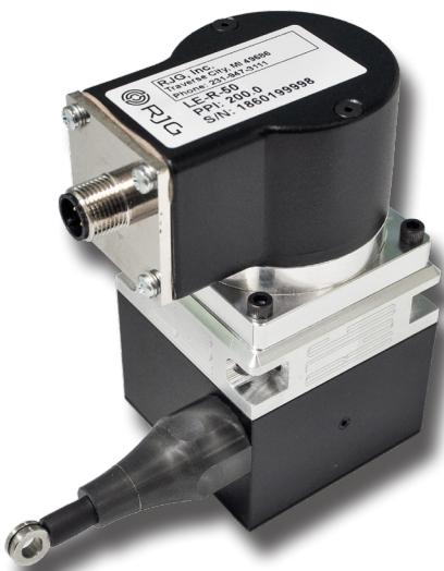
El LE-R-50-REVB es un sensor de posición / velocidad lineal montable en máquina de moldeo montado en máquina diseñado para usar con los sistemas eDART® y CoPilot®. El sensor de carrera / velocidad se puede utilizar para controlar la posición y velocidad estándar de los tornillos en la mayoría de las máquinas de moldeo por inyección.
