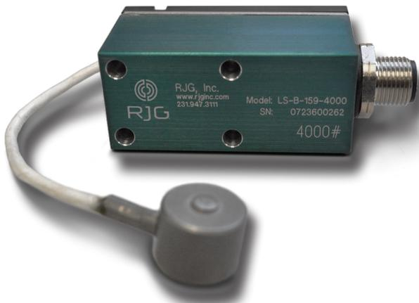
El LSB159-4000 es una galga extensométrica digital de un solo canal, indirecta (debajo del pasador), cavidad estilo botón de 0,625" (15,88 mm) presión sensor diseñado para su uso con los sistemas de control y monitoreo de procesos RJG eDART® o CoPilot®.
