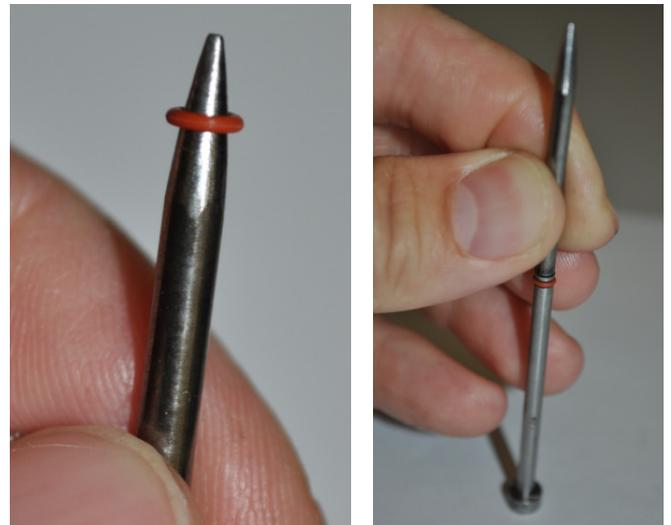
Gire el pasador a medida que se inserta para facilitar la instalación y limitar el daño potencial de la junta tórica.
