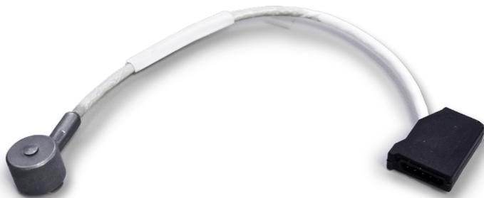
Los MCSG-B-127-125/500/2000 son sensores de presión de cavidad tipo botón de 0.50" (12,7 mm) con galgas extensométricas digitales multicanal diseñados para usarse con el control y monitoreo de procesos eDART® y CoPilot® de RJG, Inc. sistemas.
