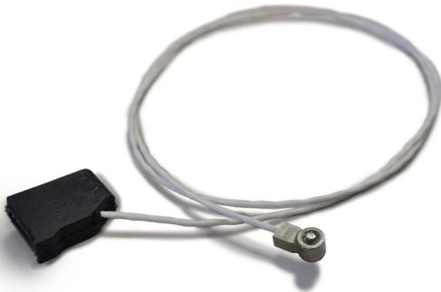
El MCSG-B-60-50/250 es un sensor de presión de cavidad de tipo botón, indirecto (con clavija inferior), multicanal, digital, de 6 mm (0.236") diseñado para su uso con el proceso RJG eDART® o CoPilot® sistema de control y seguimiento.
