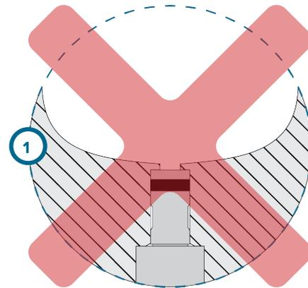
La tuerca de retención del sensor está demasiado apretada, aplastando el sensor (2 a la derecha). No apriete demasiado la tuerca de retención al instalar el sensor; el incumplimiento resultará en la destrucción del sensor.
