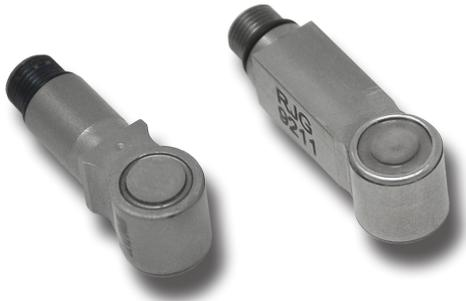
El 9211 es una cavidad piezoeléctrica de tipo botón de 6 mm (0,24 pulg.), Indirecta (clavija inferior), de canal único o multicanal. presión sensor diseñado para su uso con los sistemas de control y monitoreo de procesos eDART® o CoPilot® de RJG, Inc.
