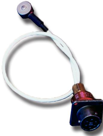
Los sensores de galgas extensométricas analógicas de un solo canal Lynx™ T-414-12, T-412-12 y T-413-12 son sensores de presión de cavidad estilo botón indirectos (debajo del pasador) de 0.50" (12,7 mm), con un vástago soldado en el cuerpo y un conector con alivio de tensión.
