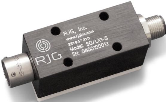
El adaptador de sensor estándar Lynx™ SG/LX1-S es un adaptador de entrada de sensor de galga extensiométrica que se puede montar en molde o platina y está diseñado para usarse con el sistema eDART® o CoPilot®. Este módulo se puede utilizar para controlar la presión del molde, los sensores hidráulicos o los sensores estilo galga extensiométrica. El adaptador del sensor se puede interconectar con el sensor de otros fabricantes siempre que la sensibilidad de la escala completa no supere los 2 mV/V.
